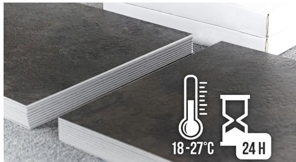
Ugradnje u područjima koja su hladnija od preporučenog utjecat će na svojstva ugradnje proizvoda LVT Dryback. Daske ili pločice bit će manje savitljive, rezanje će biti teže, a manji dijelovi teže će se izrezati. Što je temperatura niža, to je ugradnja teža. Osim toga, rizik od prekomjerne dilatacije raste smanjivanjem temperature ugradnje. Ugradnja u područjima koja su toplija od preporučenog povećava rizik od prekomernog skupljanja / razmaka između ploča.
